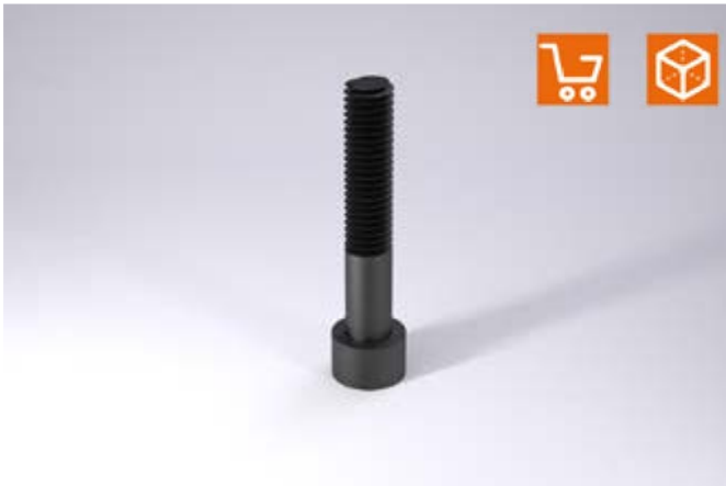
2192.10. Vis à tête cylindrique à six pans creux, DIN EN ISO 4762 - Classe de résistance mécanique 8.8
